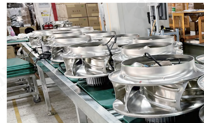
Production Line - Centrifugal Fan
